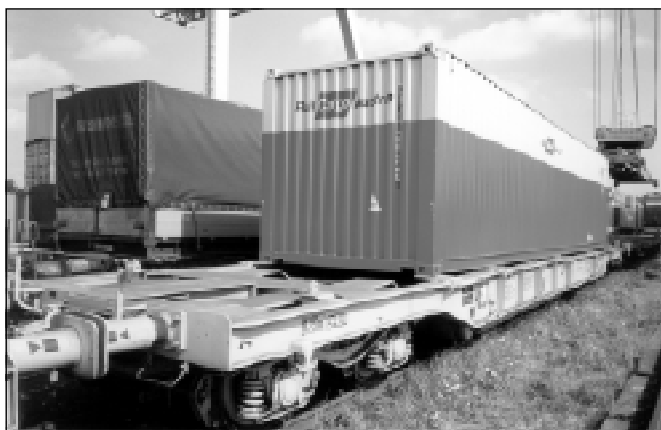
Wagony kieszeniowe Sdgmns ciągle stanowią niewielką część taboru towarowego w Polsce; mogą być na nich przewożone naczepy i kontenery Fot. F. W. Gniewczyzna
