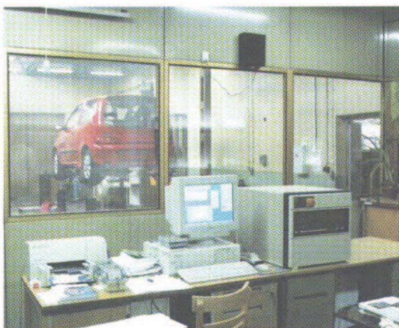
Rys. 2. System sterujący Flex Test II CTC. Fig. 2. Road simulator controller Flex Test II CTC.
