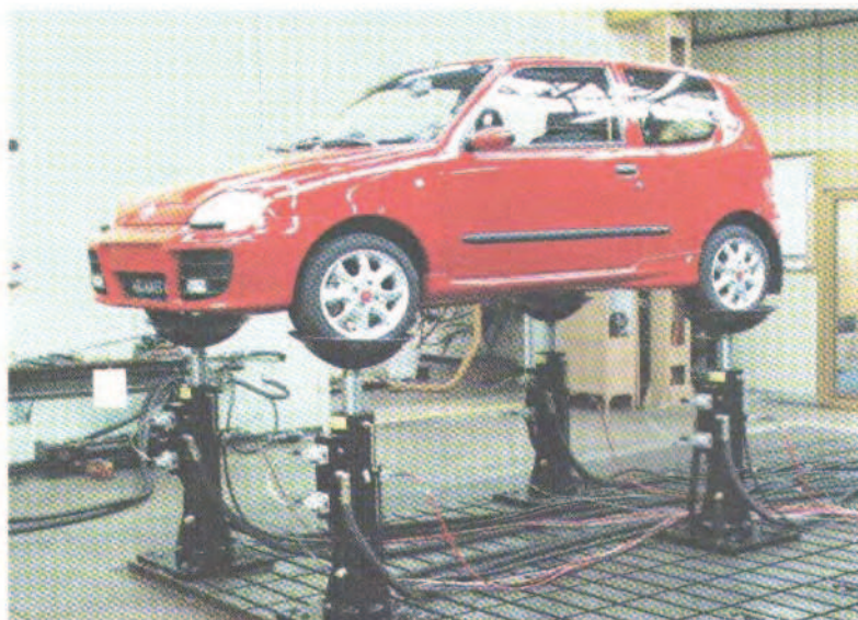
Rys. 1. Widok stanowiska hydraulicznego symulatora drogi. Fig. 1. Road simulator view.
