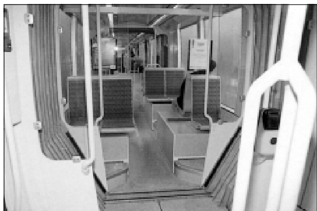
Fot. 15. SEMATO – wagonik przegubowy toczy się na podwoziu Arpège z ciekawie rozwiązany podestami
