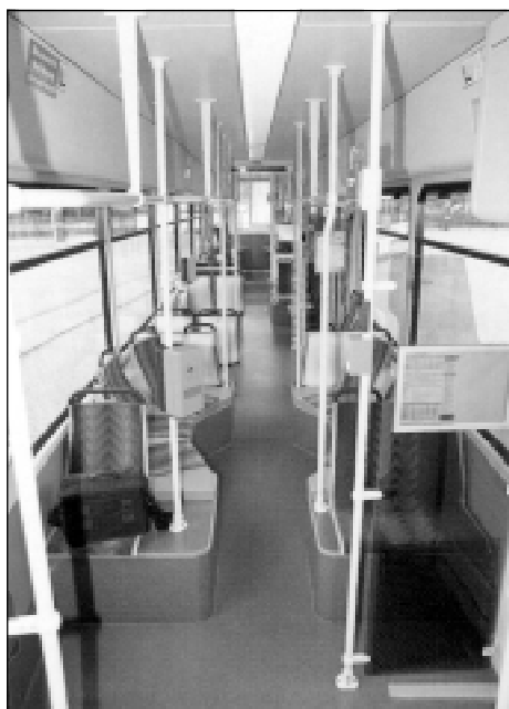
Fot. 11. Rostock – 4NBWE, wnętrze pojazdu z inteligentnie zabudowanymi wnękami kół
