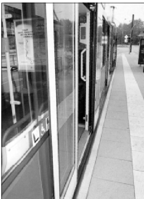
Fot. 12. 4NBWE – obrotowo-przesuwne drzwi pozostawiają małą szparę między podłogą pojazdu a peronem
