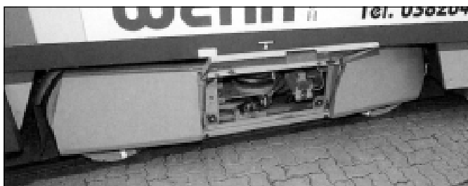
Fot. 14. Rostock – T6A2M i 4NBWE mają dźwiękochłonne fartuchy-ekrany na wózkach
