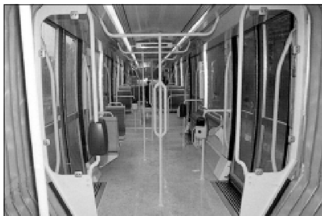
Fot. 16. SEMATO – niskopodłogowa część wagonu końcowego
