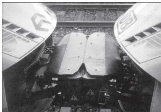
Fot. 7. Sprzęgnięte zespoły ICE 3 na stacji Arnhem, Holandia; z lewej zespół kolei NS, z prawej kolei DB
