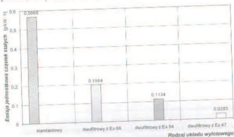
Rys. 8. Wyniki badań emisji jednostkowej cząstek stałych silnika AD3.152 (dla wybranych warunków regulacji) z systemem antysadzkowym dla filtrów przed pierwszą regeneracją Fig. 8. The research results of the individual PM emission from the engine AD3.152 (for selected regulation conditions) with the anti soot system, for filters before first regeneration.
