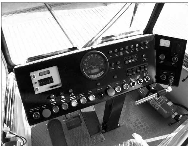
Fot. 3. Nowy pulpit motorniczego opracowany w MPK Poznań
