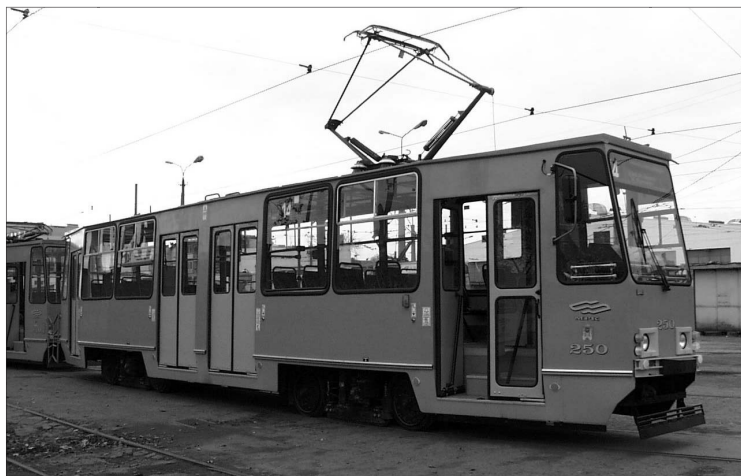
Fot. 2. Standardowa modernizacja tramwaju 105N w MPK Poznań – likwidacja stopni do wejścia na dach i zewnętrznych klap napędów drzwi
