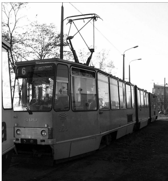
Fot. 1. Tramwaj 105N/2 – modernizacja tramwaju 105N polegająca na wstawieniu członu z częścią niskopodłogową
