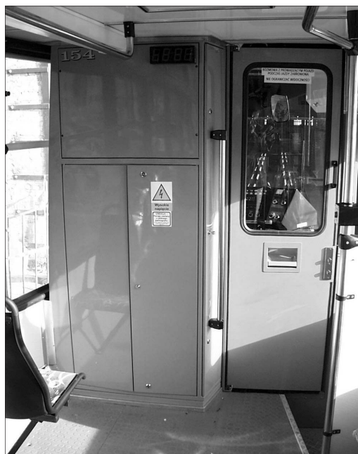
Fot. 4. Wygodzenie kabiny motorniczego i nowa szafa aparatura firmy WOLTAN
