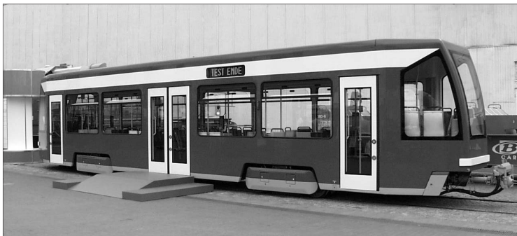
Fot. 9. Niskopodłgowy wagon doczepny bierny wykonany w H.Cegielski FPS dla przedsiębiorstwa komunikacyjnego w Rostocku
