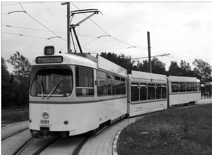
Fot. 8. Wagon GT6NF, czyli GT6 rozbudowany o człon niskopodłgowy, dla Braunschweig
