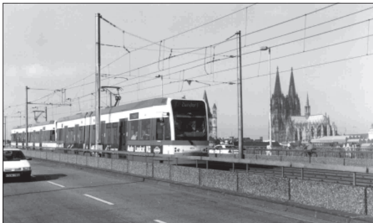
Fot. 5. Tramwaje w regionie Kolonii kursują po torach linii towarowej Hafen und Guterkehr Köln AG (HGK) – uprzednio nieelektryfikowanej; są to linie: 16 Köln – Bonn (uruchomiona ok 1980 r.), 18 Köln – Bonn (uruchomiona ok 1987 r.), 7 do Frechen; na fotografii tramwaj linii 7 Fot. J. Goździewicz
