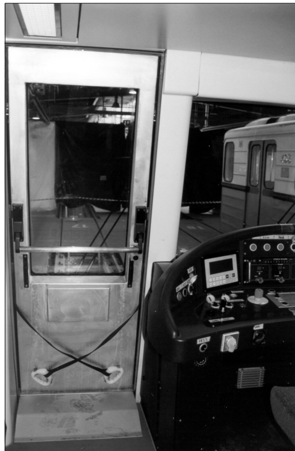
Fot. 7. Odchylane drzwi awaryjne – widok z wnętrza wagonu Fot. J. Raczyński
