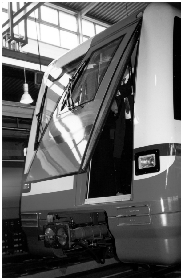
Fot. 6. Odchylane drzwi awaryjne – widok otwartych drzwi z zewnątrz Fot. J. Raczyński
