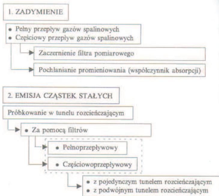
Rys. 2. Metodyka pomiarów związków toksycznych silnika spalinowego [14]
