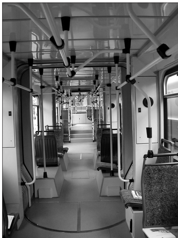
Fot. 9. Część niskopodłogowa w tramwaju 116Na/1
