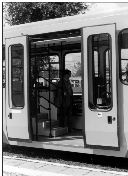
Fot. 3. Wejście do części niskopodłogowej tramwaju 112Na
