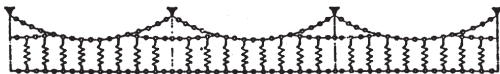
Rys. 1. Model sieci trakcyjnej
