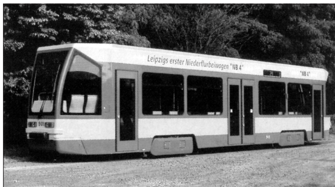
Fot. 2. Przedsiębiorstwo komunikacyjne w Lipsku (LVB); niskopodłogowy wagon doczepny NB-4 z całkowicie osłoniętymi wózkami
