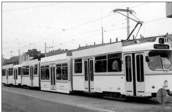
Fot. 1. Przedsiębiorstwo komunikacyjne w Braunschweigu (BVAG); niskopodłogowy pojazd typu GT6-NF; wagon silnikowy DUEWAG-LHB typu Mannheim z 1972 r. z częścią środkową z tworzywa sztucznego produkcji MGB; obecnie długość pojazdu wynosi 27,755 m, masa własna pojazdu – 28,22 t (462 kg/m 2 s), ma on 55 miejsc do siedzenia
