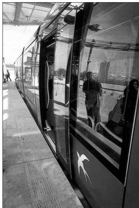
Fot. 14. TaM, Montpellier; szczelina przy peronie mostkowana jest przesuwalną deską
