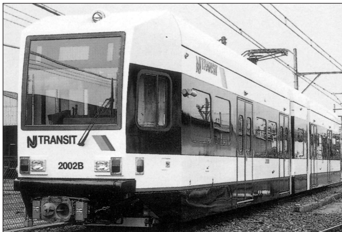
Fot. 23. New Jersey Transit; niskopodłogowy wagon kolejki miejskiej Kinki-Sharyo/Alstom Fot. Alstom
