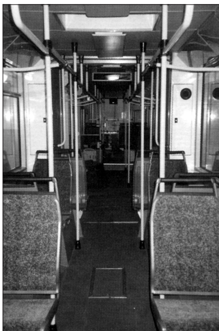
Fot. 25. ZKM Gdańsk; widok części pojazdu o średnim poziomie podłogi z części niskopodłogowej Fot. Alstom
