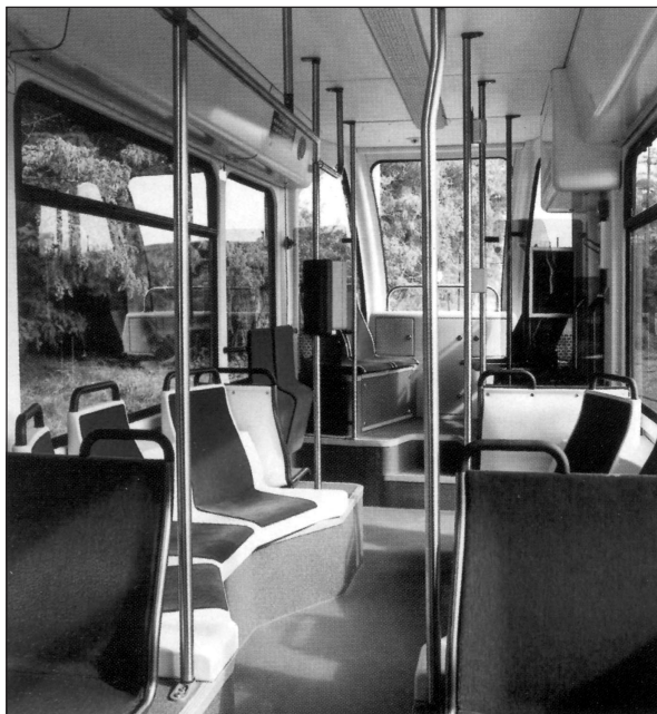
Fot. 7. LVB, Lipsk; wnętrze pojazdu – widoczna podwyższona część podłogi nad wózkiem oraz miejsca stojące
