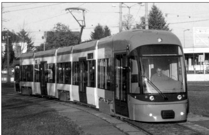
Rys. 25. GVB Graz. Pierwszy City Runner z zakładów Bombardier BWS wyposażony w napędy z silników Skoda na piasty kół oraz falowniki IGBT Kiepe
