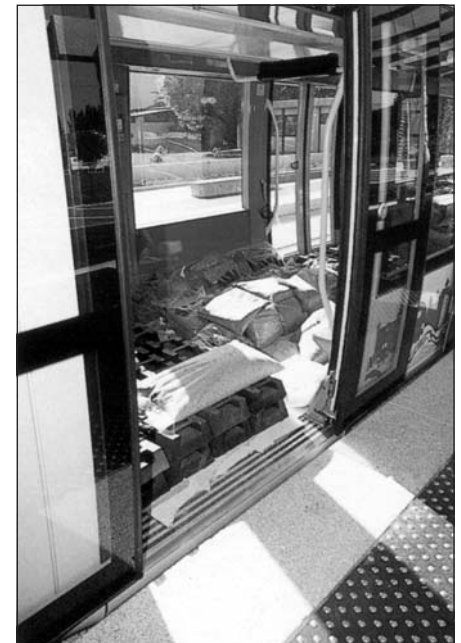
Rys. 41. Citadis 302, Lyon – wysuwany pomost wypełnia szczelinę między pojazdem a wyspą przystanku
