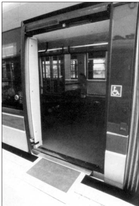
Rys. 9. Eurotram. Pomost wysuwający się przy wsiadaniu i wysiadaniu
