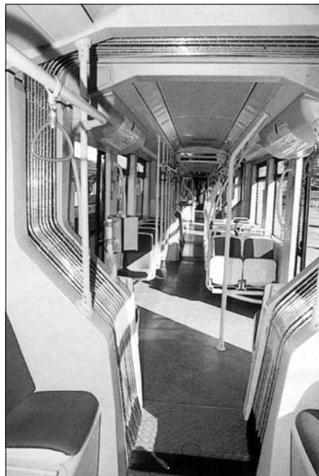
Rys. 49. Roma II, piękne wnętrze – widok miejsc nad silnikami w członie silnikowym
