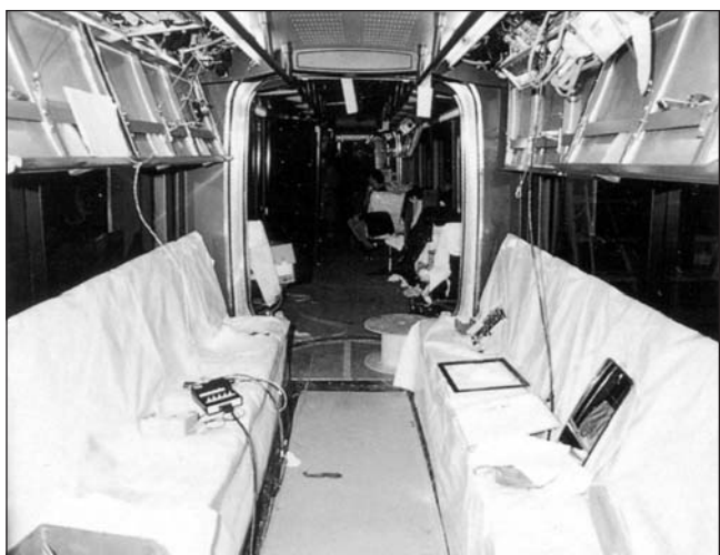
Rys. 59. Wnętrze Sirio, ławy nad wózkiem napędowym
