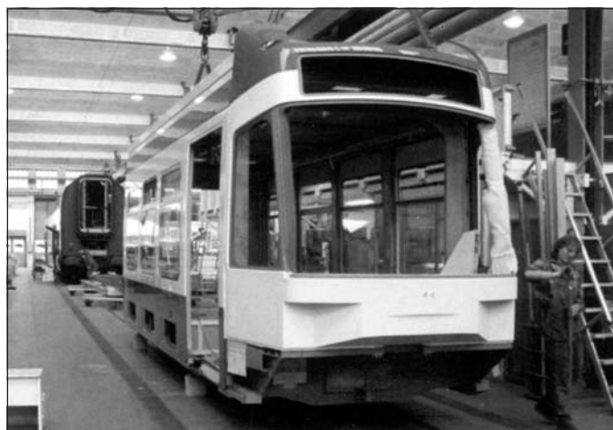
Rys. 13. Konstrukcja hybrydowa produkcji Alusuisse, zastosowana w zakładach Cobra – człon przedni
