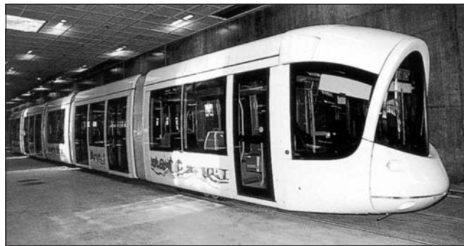
Rys. 27. SLTC Lyon. Jeden z pierwszych pojazdów Citadis 302 z całkowicie osłoniętym podwoziem na dziedzińcu fabrycznym
