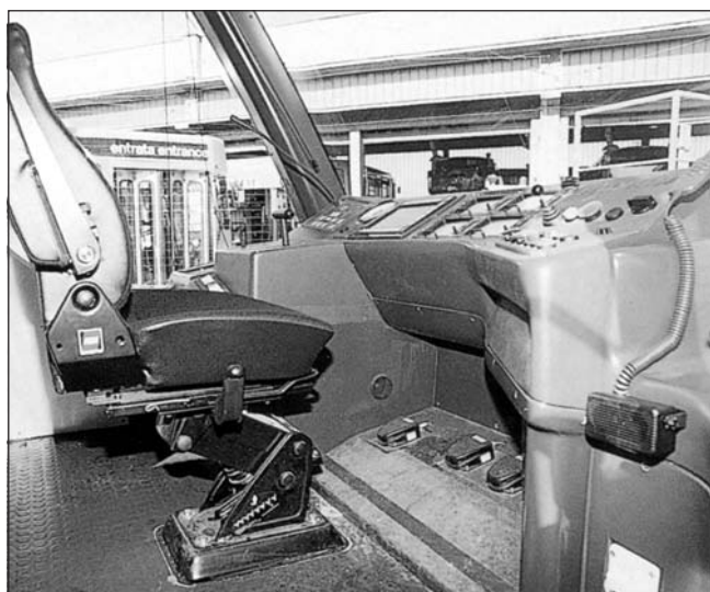
Rys. 45. Roma II. Bardzo obszerna kabina motorniczego z osobnymi drzwiami
