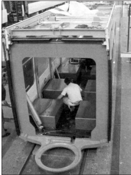
Rys. 16. Cobra – ostatni człon od strony „lektyki”; konstrukcja skręcana śrubami – Alugrip, zmontowany dach warstwowy; na pierwszym planie pierścień nośny „lektyki”, pod obudowami napędy
