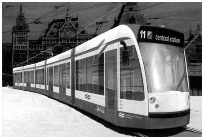
Rys. 29. GVB Amsterdam – tak będzie wyglądał nowy Combino; kabinę wydłużono o 30 cm
