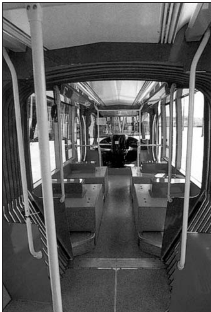
Rys. 39. Citadis 302, Lyon – wnętrze pojazdu jeszcze bez siedzeń
