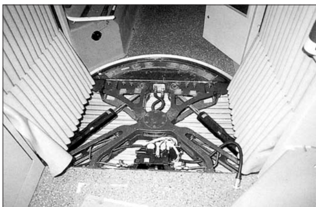
Rys. 7. GT8N2. Hydraulika Liebherr amortyzująca przechyły na łukach
