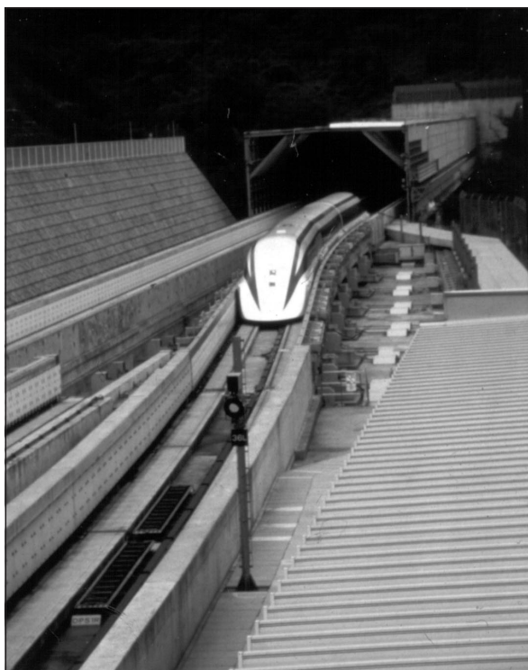
Rys. 4. Japoński pociąg Maglev na testowej trasie Yamanashi podczas przejeżdżania przez zwrotnicę Fot. W. Völkening
