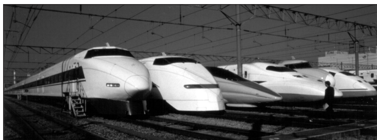
Rys. 1 Kształt głowicy japońskich pociągów dużej prędkości (od lewej do prawej): seria 100, 300, 500, 700, 0 i pociąg próbnny 300X Fot. W. Völkening
