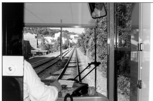
Na trasie linii T2, po prawej stronie toru widoczny jest sygnalizator przejazdowy
