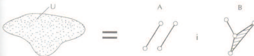
Rys. 4. Znalezione przy przyjętych założeniach ( k=2 , p_2=0 ) postaci łańcucha średniczącego Fig. 4. Solutions of Intermediate Chain body for bases ( k=2 , p_2=0 )
