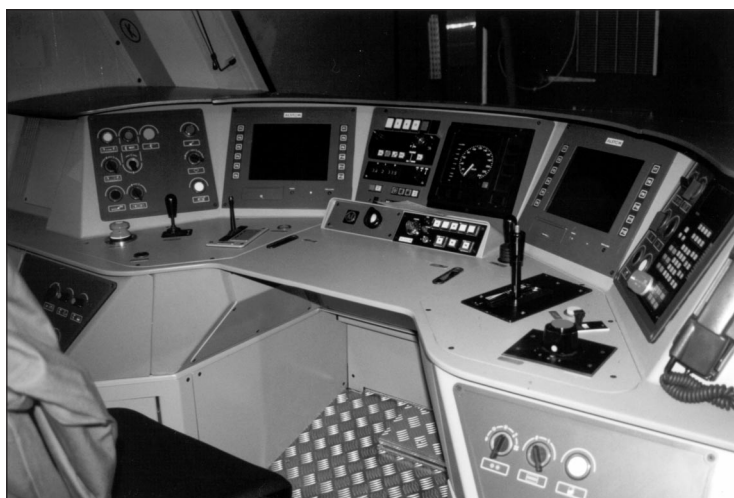
Fot. 2. Kabina maszynisty lokomotywy PRIMA EL 4200
