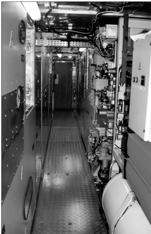
Fot. 3. Przestronny przedział maszynowy z przejściem środkiem lokomotywy
