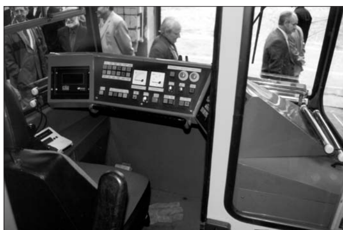
Fot. 3. Najobszerniejszym w kraju programem modernizacji objęto 40 wagonów 805Na w MPK Łódź Sp. z o.o. Zastosowano m.in. impulsowy układ rozruchu i hamowania prądu przemiennego, przetwornicę statyczną, odbierak prądu, zmodernizowany wózek z wkładami gumowymi, tapicerowane siedzenia dla pasażerów, elektroniczną informację zewnętrzną i wewnętrzną dla pasażerów Fot. Ł. Stefańczyk, J. Raczyński
