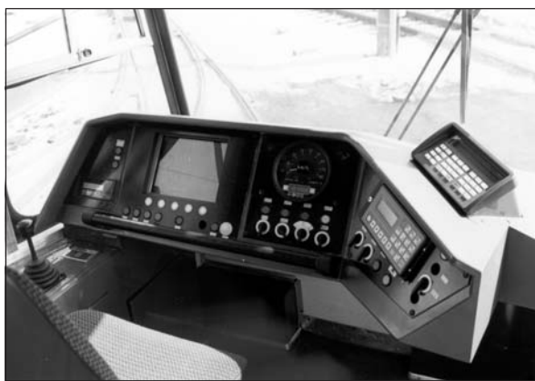
Fot. 5. Zmodernizowany w sierpniu br. tramwaj 105N z Tramwajów Warszawskich. Zastosowano w nim układ impulsowy rozruchu prądu stałego oraz najbardziej nowatorski i funkcjonalny w kraju pulpit sterowniczy motorniczego produkcji ZAE WOLTAN Fot. M. Stiasny
