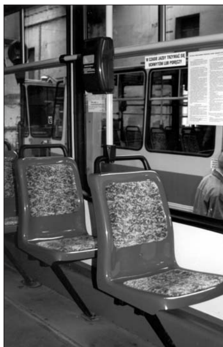
Fot. 3. Najobszerniejszym w kraju programem modernizacji objęto 40 wagonów 805Na w MPK Łódź Sp. z o.o. Zastosowano m.in. impulsowy układ rozruchu i hamowania prądu przemiennego, przetwornicę statyczną, odbierak prądu, zmodernizowany wózek z wkładami gumowymi, tapicerowane siedzenia dla pasażerów, elektroniczną informację zewnętrzną i wewnętrzną dla pasażerów Fot. Ł. Stefańczyk, J. Raczyński
