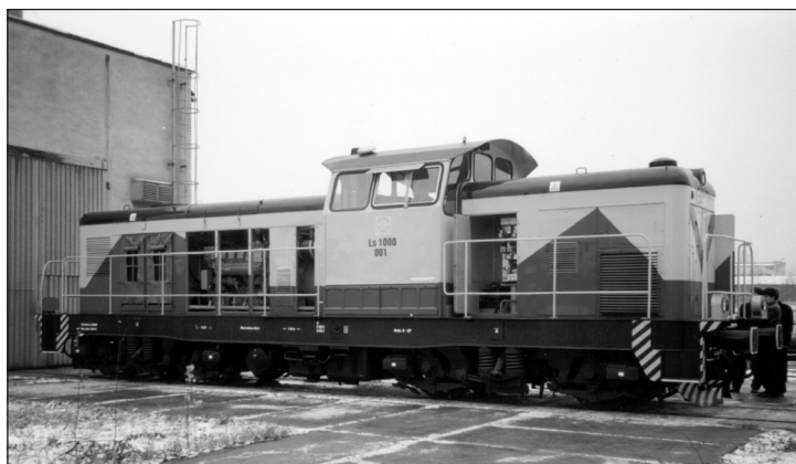
Fot. 2. Zmodernizowana lokomotywa SM42
