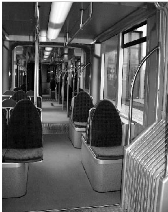
Rys. 5. Szerokie przejście w module z wózkiem kołowym
