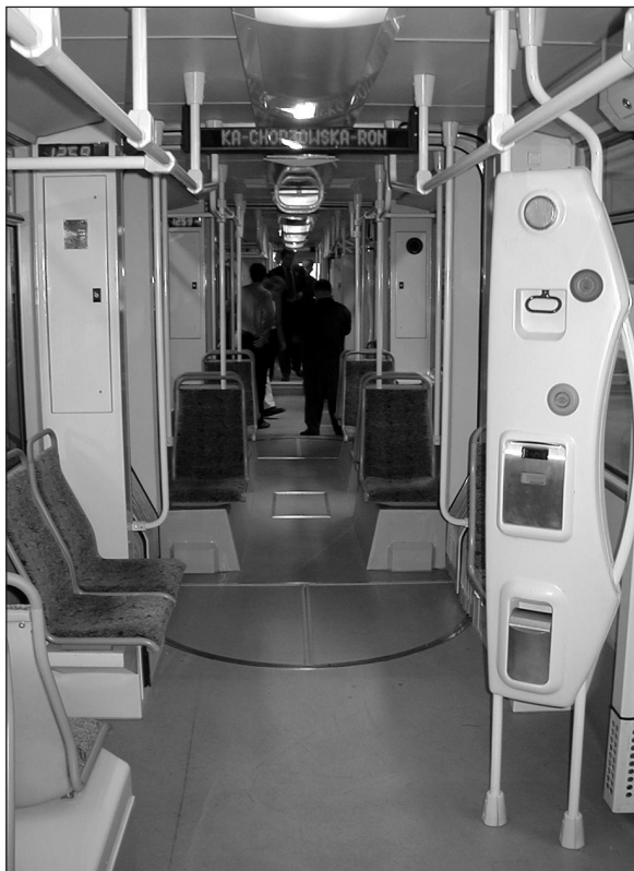
Wielofunkcyjna kolumna zlokalizowana w strefie drzwi
