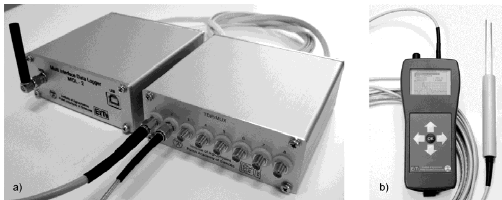
Fot. 1. Elementy składowe sieci monitoringu wilgotności, temperatury i zasolenia gleby, opracowane w IA PAN w Lublinie: a) MIDL-2 – modem komunikacyjny GPRS między stacją pomiarową i serwerem internetowym, TDR/MUX – ośmiokanałowy miernik TDR wilgotności, temperatury i zasolenia gleby; b) FOM/mts oraz FP/mts – jednokanałowy, ręczny miernik TDR oraz sonda do pomiaru wilgotności (techniką TDR), temperatury i zasolenia gleby (fot. W. Skierucha)
