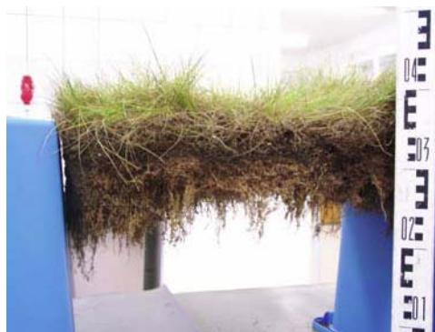
Fot. 5. System korzeniowy traw rozwinięty na podłożu piaszczystym (fot. H. Orzeszyna)
