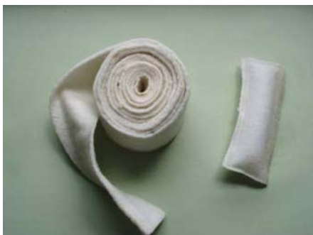
Fot. 1. Prototyp taśmy geokompozytu „Aquatube” oraz spęczniały odcinek geokompozytu z zaabsorbowaną przez SAP wodą (fot. H. Orzeszyna)
