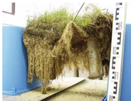
Fot. 3. System korzeniowy traw rozwinięty na podłożu piaszczystym z geokompozytem założonym pionowo (fot. H. Orzeszyna)
