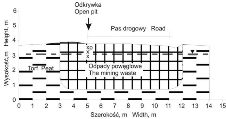
Rys. 3. Przekrój II przez drogę wykonaną na torfach – obiekt 3: x, p – jak pod rys. 1
