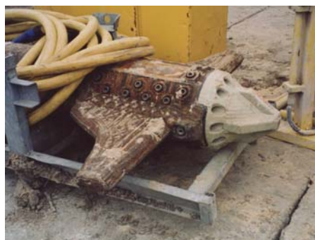
Fot. 4. Końcówka skrzydła stosowanego w metodzie wibracyjnej (fot. M. Borys )
