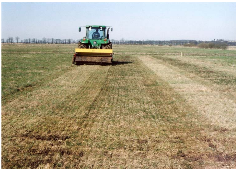
Fot. 1. Siewnik do siewu bezpośredniego – Vredo (fot. R. Dembek)
