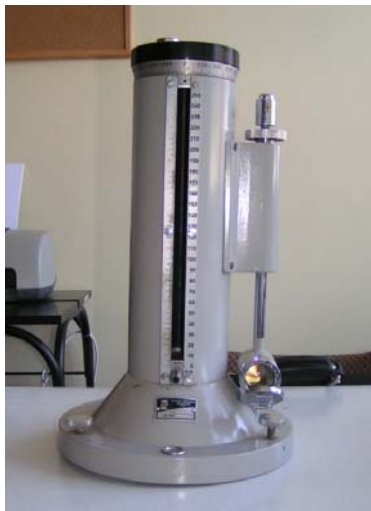
Fot. 2. Widok użytego w pomiarach mikromanometru ASKANIA model MK-2 (fot. M. Cieślak)
