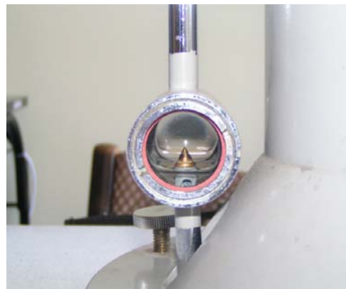
Fot. 3. Dolny zbiornik mikromanometru ASKANIA wraz z ostrzem pomiarowym (fot. M. Cieślak)
