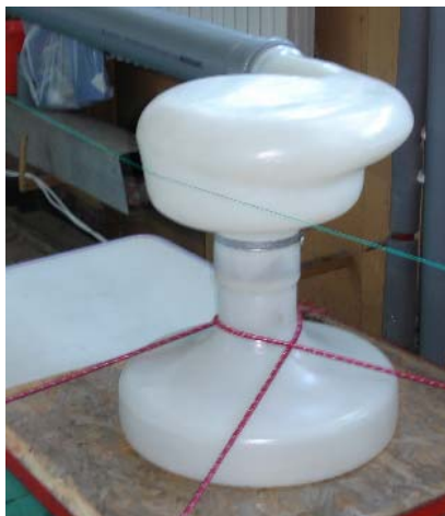
Fot. 1. Separator fazy stałej z efektem Coandy model Aquatron 90 na stanowisku badawczym (fot. Z. Dąbek)
