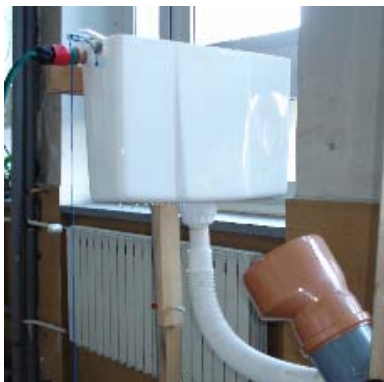
Fot. 3. Zbiornik wody splukującej na laboratoryjnym stanowisku badawczym (fot. Z. Dąbek)
