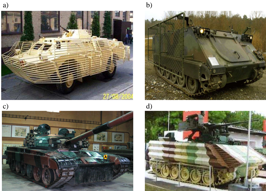
Rys. 5. Osłony pasywne i reaktywne wozów bojowych: a) osłona prętowa, b) wielowarstwowa struktura ochronna, c) ładunki osłony reaktywnej prostopadłe, d) ładunki osłony reaktywnej pochylonej
