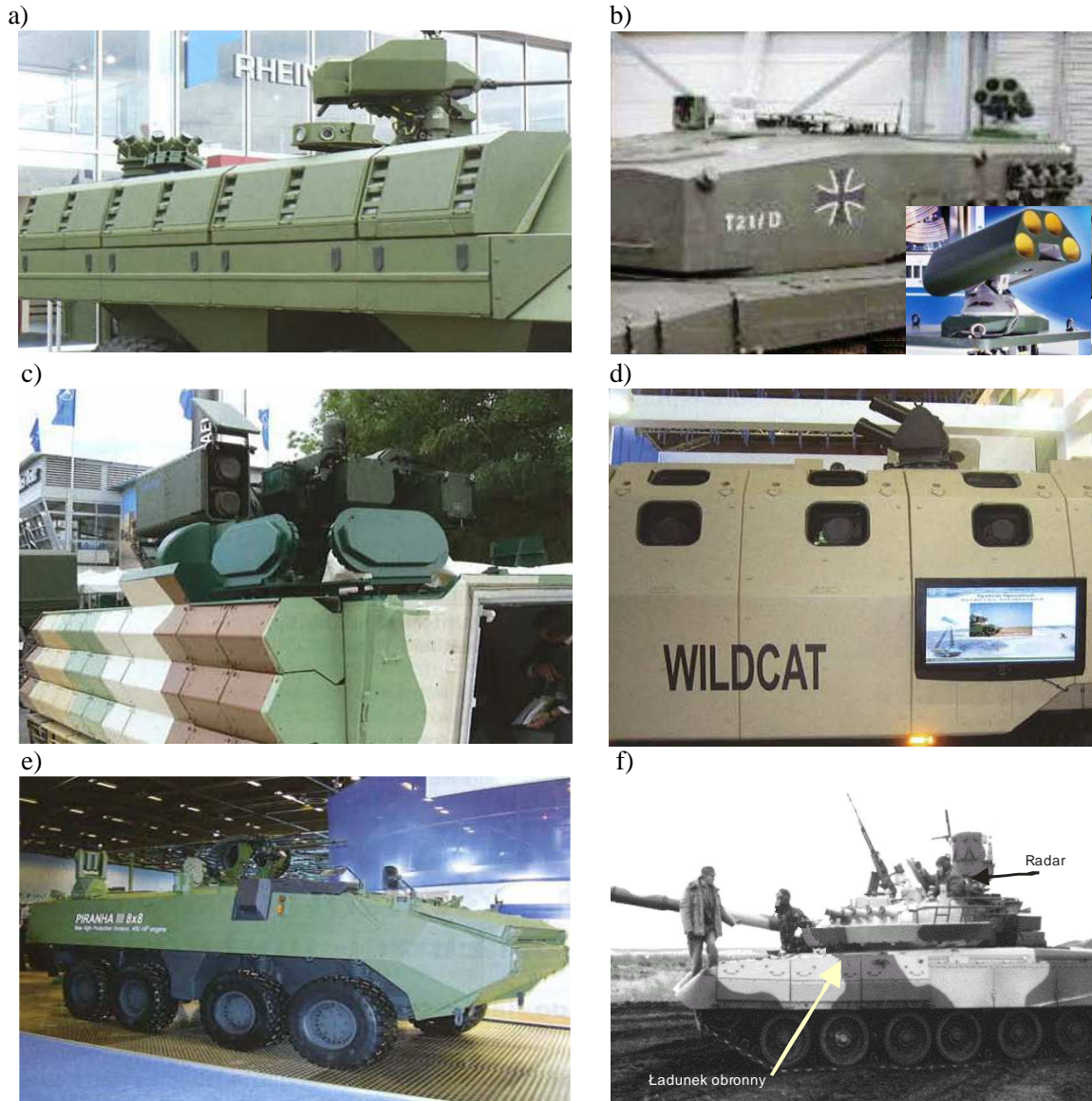
Rys. 15. Wybrane systemy aktywnej ochrony pojazdów: a) AMAP-ADS (GER), b) AWISS (GER), c) ASPRO TROPHY (ISR), d) Iron Fist (ISR), e) LED 150 (SWE), f) ARENA (RUS)
