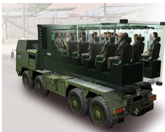
Rys. 17. Wnętrze kontenera MuConPers
