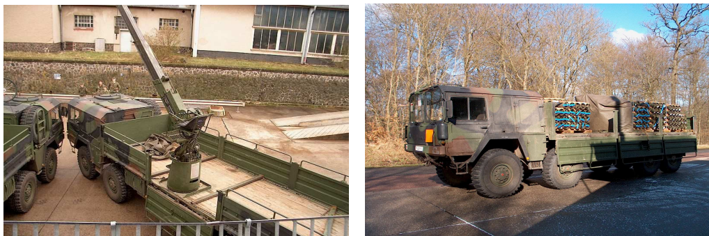
Rys. 9. Pojazdy LKW 10 T mil gl, z zamontowanymi hydraulicznymi dźwigami samochodowymi
