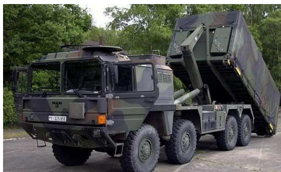
Rys. 12. LKW 15 T mil gl MULTI z platformą do transportu ładunków wymagających przewozu pod lekkim przykryciem typu oponcza brezentowa
