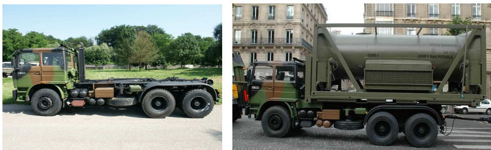
Rys. 3. Renault G290.26 z urządzeniem samozaładowczym typu AMPLIROLL
