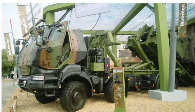
Rys. 6. Renault KERAX z zamontowaną opancerzoną kabiną kierowcy
