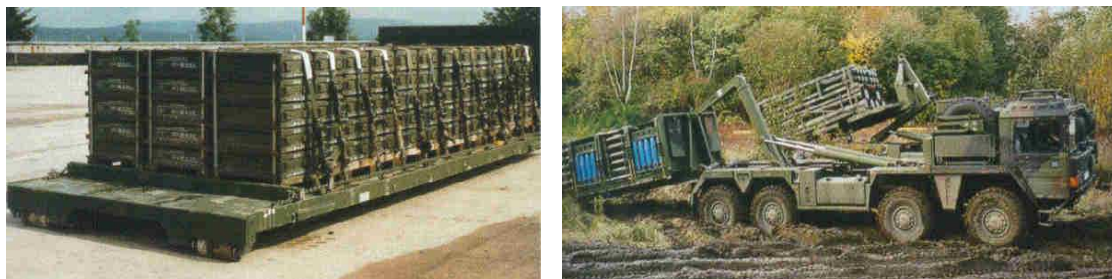
Rys. 11. Platforma ładunkowa typu Flat Rack oraz LKW 15 T mil gl MULTI w czasie rozładunku tego typu platform
