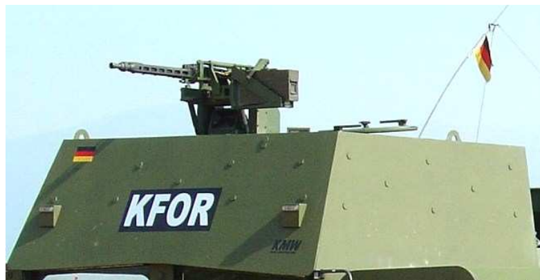
Rys. 15. Kabina pojazdu LKW MULTI 2 FSA (A3) z zamontowanym karabinem maszynowym 7,62 mm – MG 3
