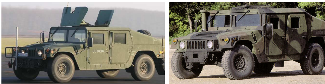
Rys. 1. HMMWV w wersjach 1043 (pancerz stalowo – laminatowy) i 1151 (pancerz wielowarstwowy) – przykład modernizacji i rozwoju konstrukcji podyktowany potrzebą podwyższenia poziomu ochrony załóg
