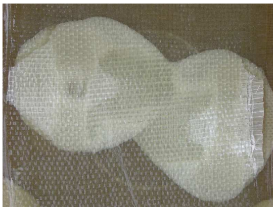
Laminat po badaniach balistycznych. Strona tylna
