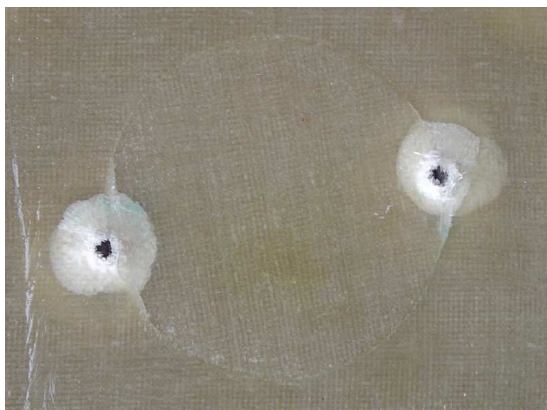
Laminat po badaniach balistycznych. Strona frontowa
