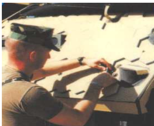
Rys. 14. Naprawa pancerzy z warstwą ceramiczną
