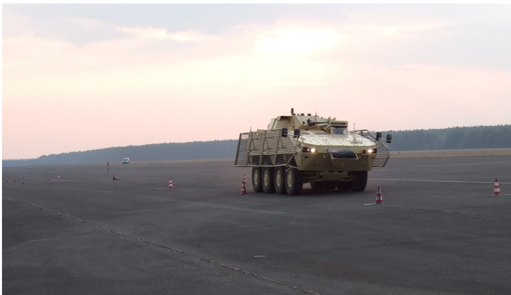
Rys. 7. Obiekt – KTO Rosomak w wersji M-1 wyposażony w system dodatkowego opancerzenia i lekki system osłon przeciwko pociskom kalibru 7,62mm i 14,5mm oraz pociskom wystrzeliwanym z RPG-7
