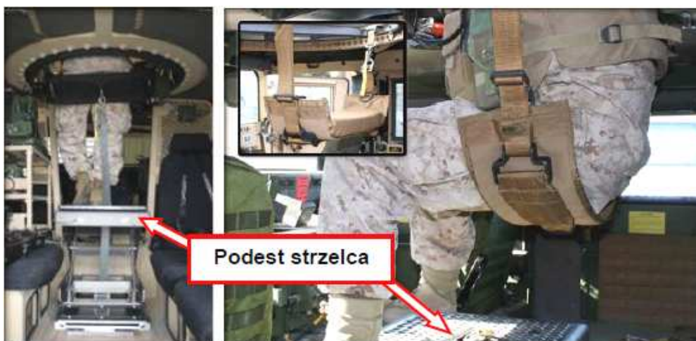
Rys. 5. Umieszczenie podestu strzelca. Z lewej strony w pojeździe Cougar, z prawej w HMMWV
