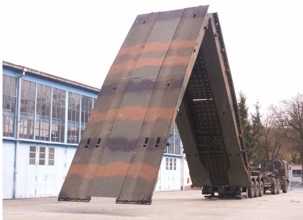
Rys. 8. MS-20 w trakcie rozkładania
