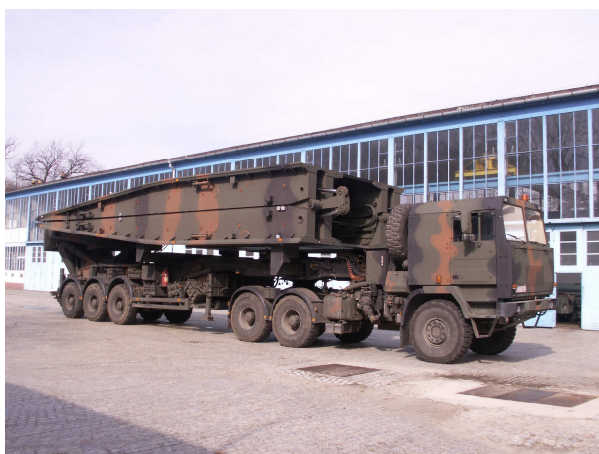
Rys. 9. MS-20 w pozycji transportowej
