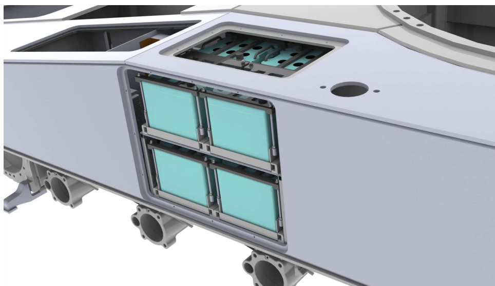
Rys. 9. Komora akumulatorów oddzielona od przedziału załogi
