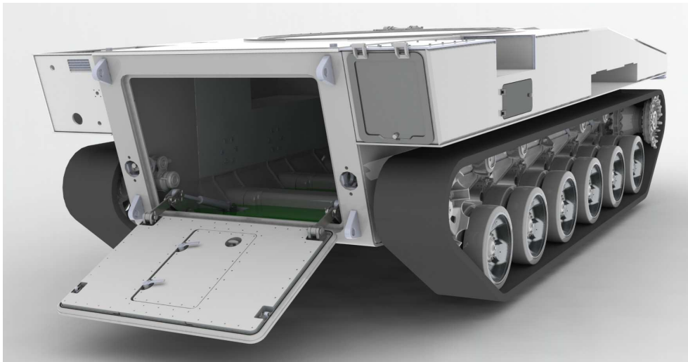
Rys. 7. Tylna rampa z napędem hydraulicznym
