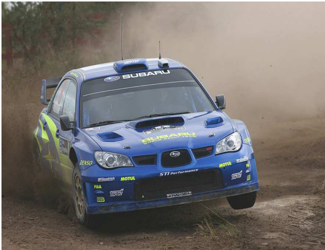
Rys. 3. Zjawisko odrywania się przedniego wewnętrznego (od strony środka skrełu) koła pod wpływem działania siły napędowej i odśrodkowej
