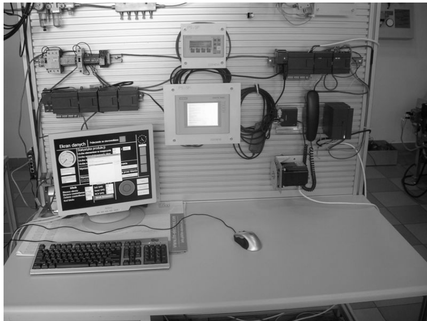
Rys. 3. Widok stanowiska laboratoryjnego do symulowania możliwości komunikacyjnych z systemami automatycznymi
