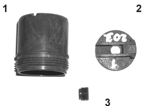
Rys. 8. Części zespołu poddane badaniom: 1) tuleja, 2) talerzyk, 3) element gwintowany
