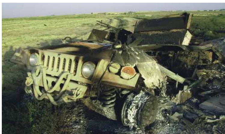
Rys. 1. Polski HMMWV po wybuchu miny o masie 6 kg
