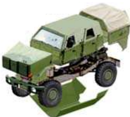
Rys. 6. Schemat modułowej budowy Dingo 1
