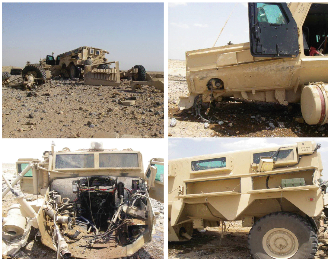
Rys. 2. Amerykański Cougar 6x6 po eksplozji improwizowanego urządzenia wybuchowego IED o szacowanej masie około 136 - 226 kg
