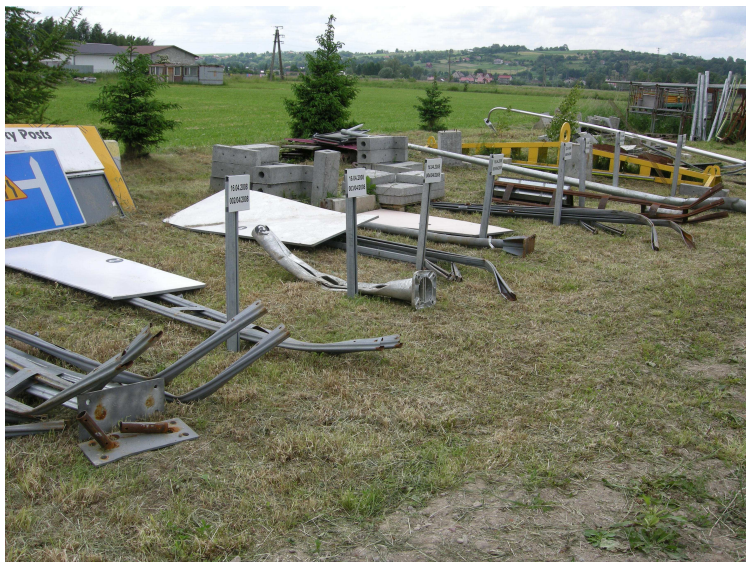
Rys. 2. Elementy wyposażenia drogi (system bezpieczeństwa biernego) po testach zderzeniowych z samochodami przeprowadzonych w firmie WIMED – Tuchów
