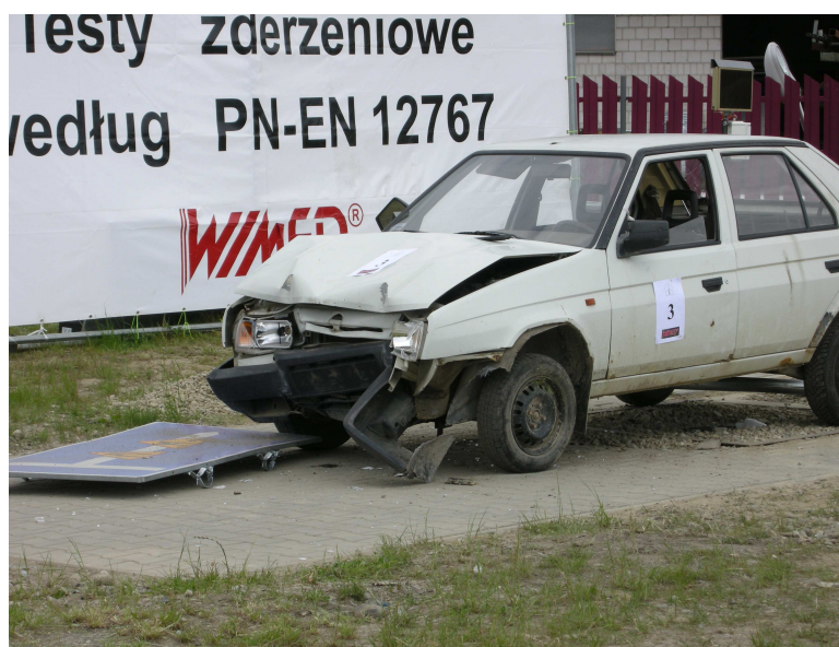
Rys. 3. Test zderzenia samochodu osobowego z elementem wyposażenia drogi (system bezpieczeństwa biernego) wykonany w firmie WIMED – Tuchów w dniu 6 czerwca 2008 r.
