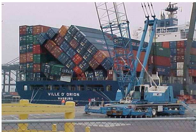
Rys. 5. Skutki niewłaściwego rozplanowania masy kontenerów
