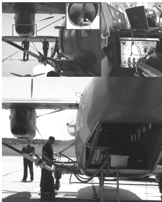
Rys. 3. Miejsce zamocowania sondy poboru spalin i umieszczenia analizatora
