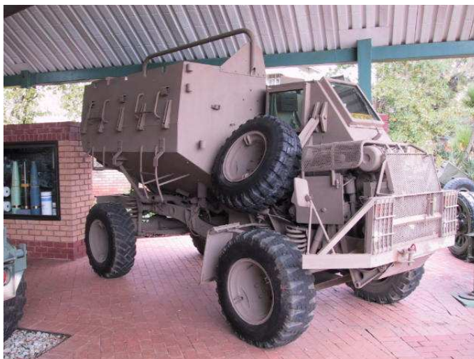
Rys. 1. Pojazd minoodporny Buffel, jeden z pierwszych pojazdów typu MRAP
