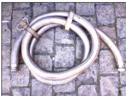
Rys. 19. Wężę tłoczne kwasoodporne
