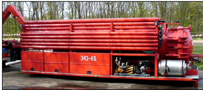
Rys. 64. Kontener-cysterna z wyposażeniem do przepompowywania cieczy ropopochodnych lub agresywnych firmy Dromech
