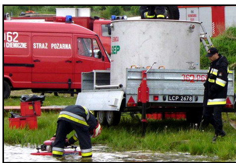
Rys. 61. Separator olejowy wraz z pompą pływającą
