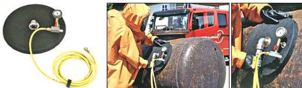
Rys. 45. Poduszka podciśnieniowa, uszczelniająca z drenażem
