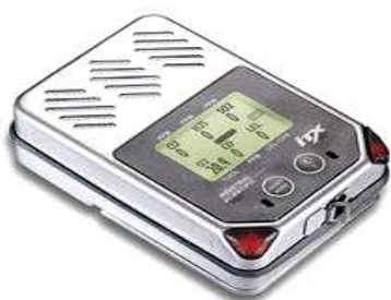
Rys. 5. Detektor wielogazowy ITX Detekcja: O 2 , CO, H 2 S, SO 2 , NO, NO 2 , H HCN, NH 3 , H 2 , PH 3 , ClO 2 , gazy palne, in
