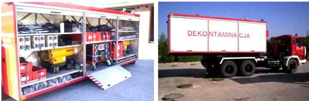
Rys. 65. Kontener – dekontaminacja z namiotem pneumatycznym oraz wyposażeniem do likwidacji skażeń uszkodzonych po zdarzeniu masowym
