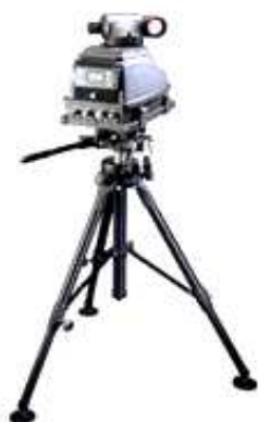
Rys. 11. RAPID – spektrometr pracujący w podczerwieni (FTIR) do detekcji skażeń chemicznych powietrza z dużej odległości
