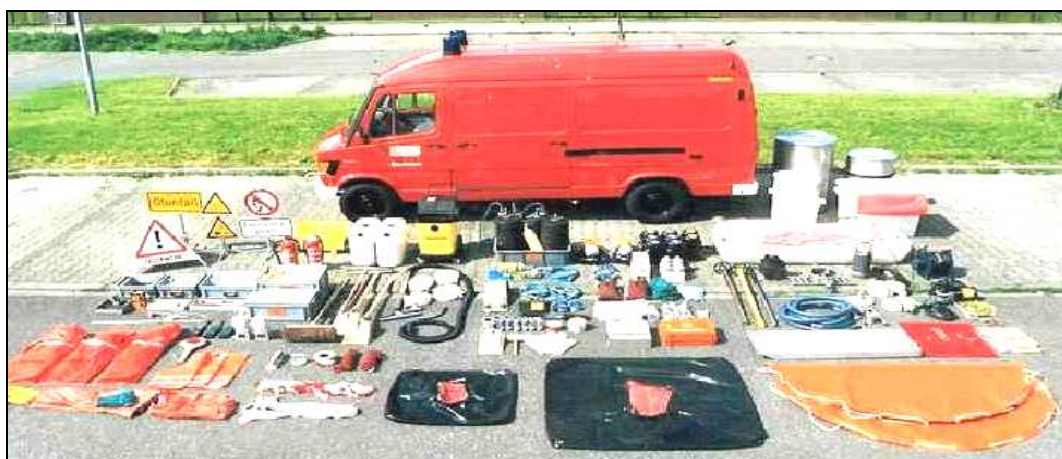
Rys. 35. Podstawowy sprzęt uszczelniający oraz przeznaczony do zbierania substancji niebezpiecznych w strefie zagrożenia znajdujący się na wyposażeniu pojazdu SLR ChemEko firmy Gimaex – Schmitz
