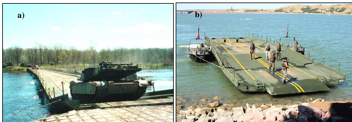
Rys. 12. Most pontonowy IRB: a) przejazd obciążenia po moście, b) widok przygotowanego promu do załadunku
