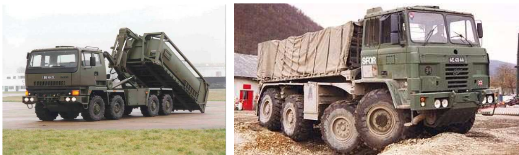
Rys. 6. Pojazdy LEYLAND (od lewej) i FODEN z systemami samozaładowczymi
