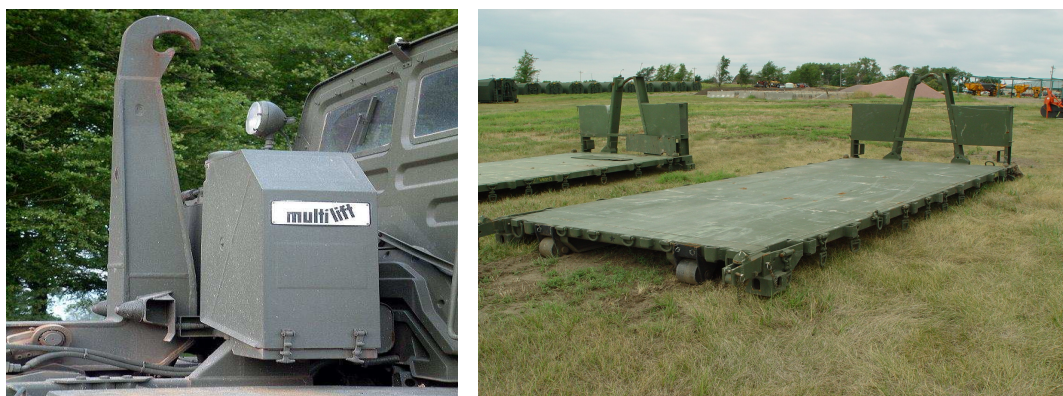
Rys. 4. Hakowy system ładunkowo – rozładunkowy MULTILIFT firmy CARGOTEC oraz platforma ładunkowa typu Flat Rack
