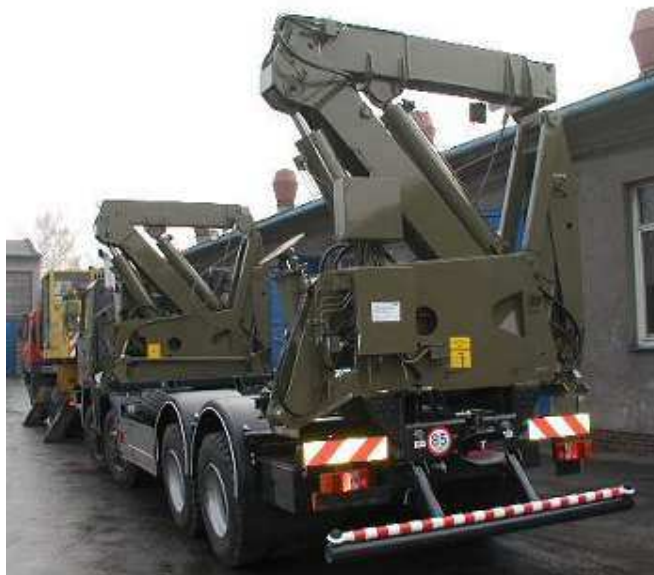
Rys. 5. Zestaw do bocznego przeładunku kontenerów
