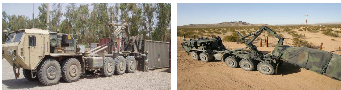
Rys. 14. Ciężarówka typu PLS w czasie realizacji zadań manipulacyjnych związanych z przemieszczeniem kontenera oraz platformy ładunkowej typu Flat Rack
