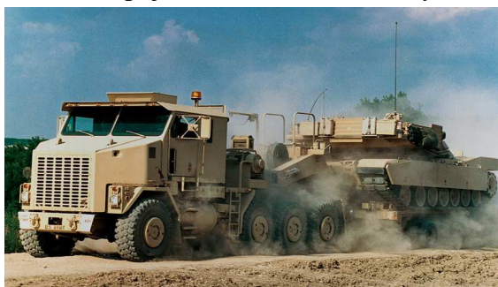
Rys. 17. HET przewożący na przyczepie niskopodwoziowej czołg M1 ABRAMS
