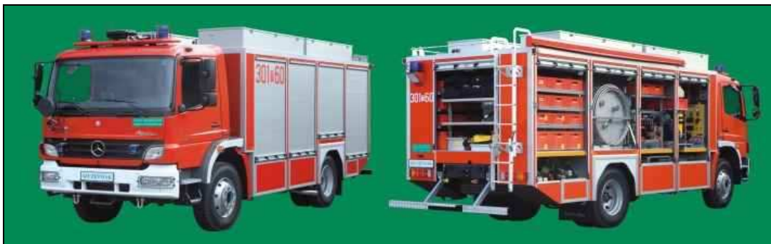
Rys. 2. Pojazd specjalny średni ratownictwa chemiczno-ekologicznego (SRChemEko 1 ) na podwoziu MercedesBenz Atego 1529 AF 4x4 zabudowany przez firmę Szcześniak
