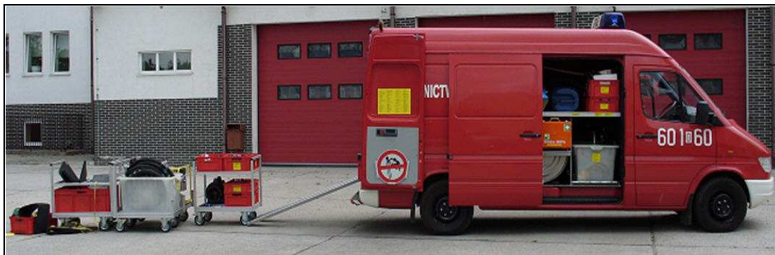
Rys. 1. Pojazd specjalny lekki ratownictwa chemiczno-ekologicznego (SLRChemEko) na podwoziu Mercedes Sprinter 312S zabudowany przez firmę Schmitz
