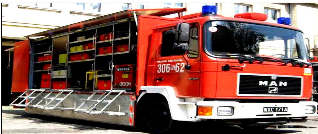
Rys. 3. Pojazd specjalny ciężki ratownictwa chemiczno-ekologicznego (SCRChemEko) na podwoziu MAN 12.232 zabudowany przez firmę Schmitz
