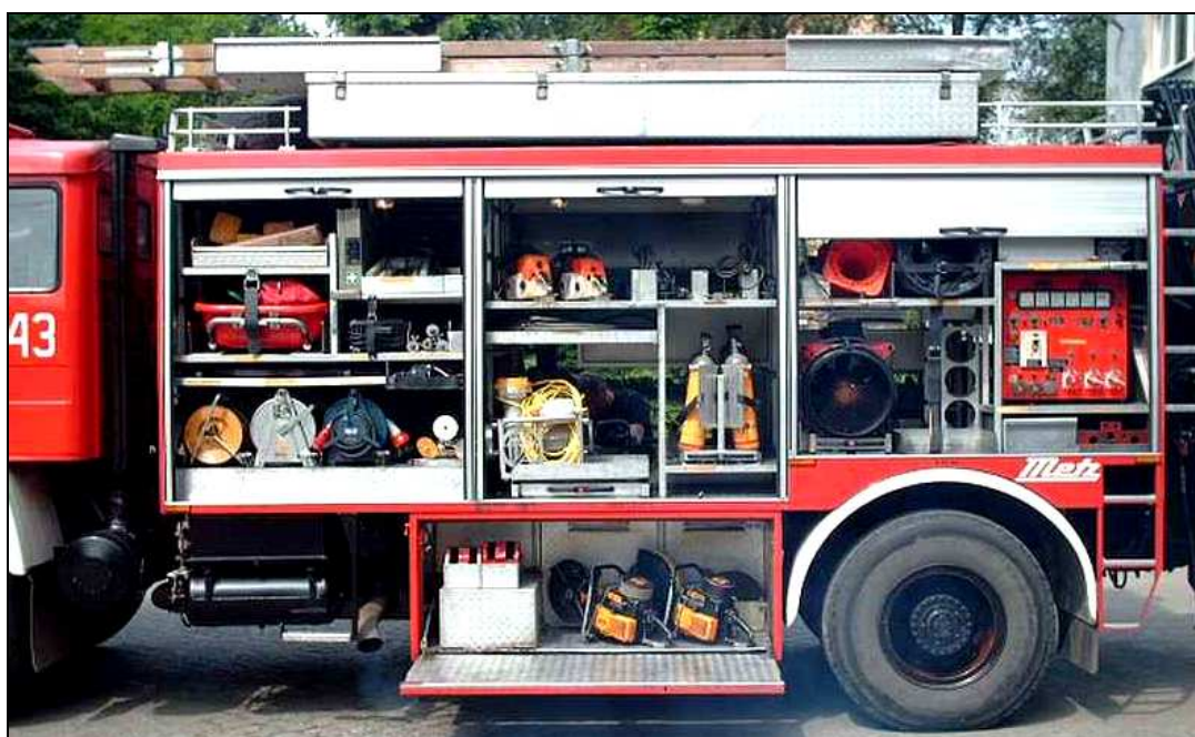
Rys. 4. Pojazd specjalny ciężki ratownictwa technicznego (SCRT) na podwoziu Jelcz 415 zabudowany przez firmę Metz
