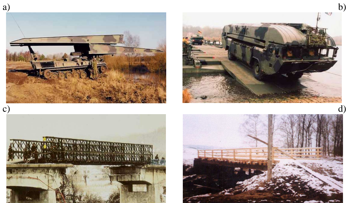
Rys. 2. Przykłady mostów wojskowych: a) towarzyszące, b) pływające, c) składane i d) prowizoryczne
