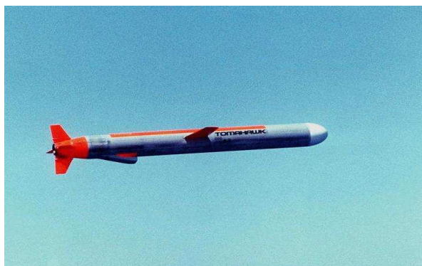
Rys. 5. BGM-109 Tomahawk amerykański taktyczny pocisk manewrujący, w zależności od wersji - wyrzeliwany z okrętów nawodnych i podwodnych, a w przeszłości także wyrzutni lądowych.
