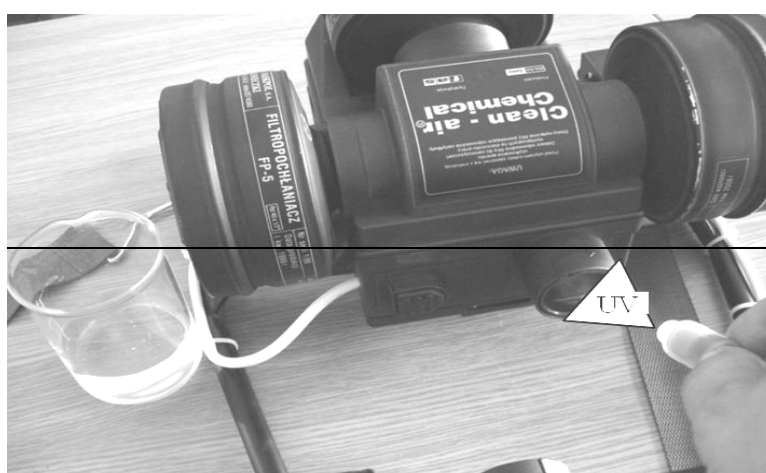
Rys. 3. Sposób sprawdzenia obecności luminoforu w kanale tłocznym filtrowentylacyjnego aparatu oddechowego odzieży barierowej
