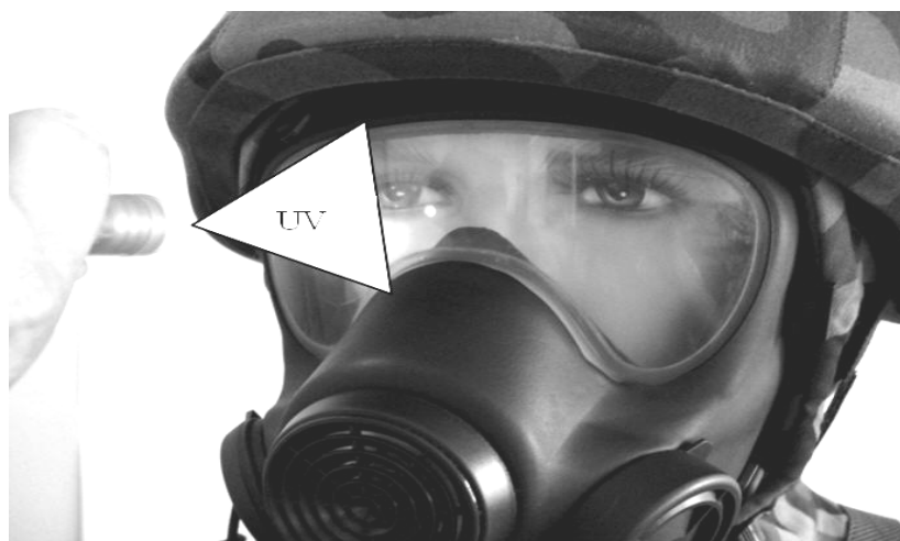
Rys. 2. Sposób sprawdzenia obecności luminoforu na skórze w okolicach oczu. Na zdjęciu widoczny jest manekin. Żołnierz w masce musi zamknąć oczy, ponieważ promieniowanie UV jest szkodliwe dla wzroku
