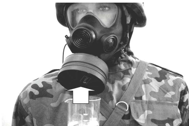
Rys. 1. Sposób sprawdzania filtropochłaniacza maski przeciwgazowej za pomocą par olejku eterycznego lub luminoforu
